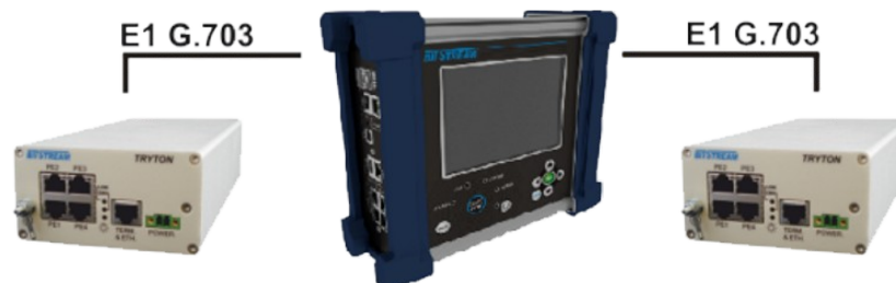
Rys. 3. Testy „in service” pozwalają na monitorowaniu pracującego traktu E1 pod kątem występowania alarmów i błędów.
